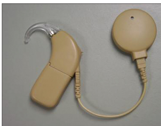
Fig. 2. Partie externe d'un implant Clarion séries Platinum intégrant dans un contour d'oreille le microphone, le logement pour les piles, le processeur externe, et l'antenne permettant le contact avec la partie implantée
